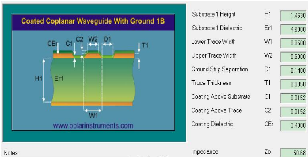
图 5.5 50Ω 阻抗的计算方法参考
